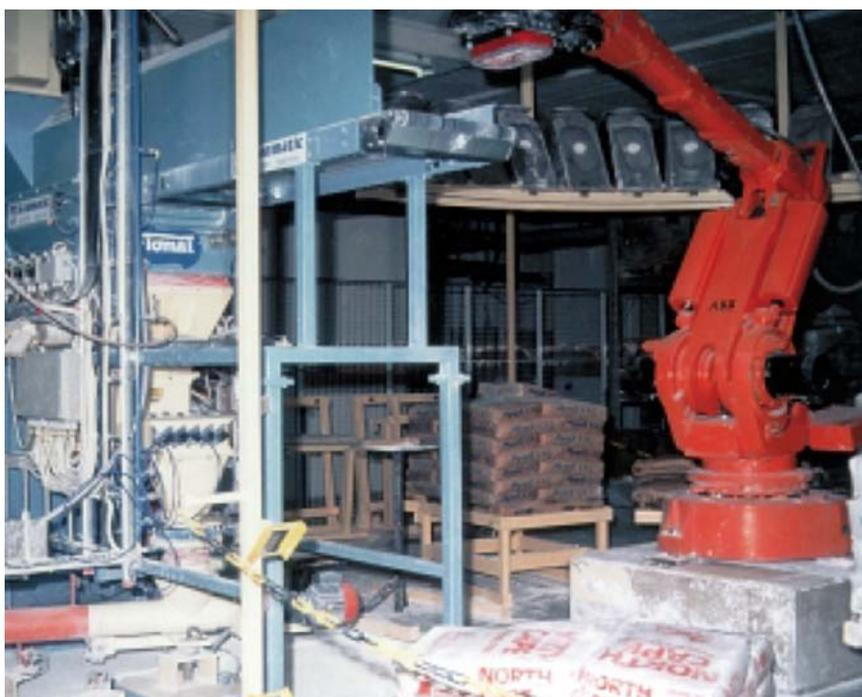
Используется десять различных химических веществ. ABB робот контролирует разгрузку упаковок.
