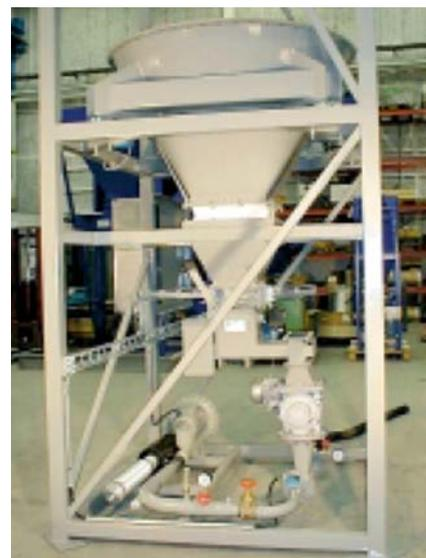
Введение активированного угля в канал отработанного газа для снижения уровня диоксида и ртути в медеплавильной печи Болиден Минерал в Рёнскэрсверкен на севере Швеции. Быстроразъемная установка, состоящая из опорожнителя промышленных упаковок, питателя, пневматической конвейерной системы, инъекционного аппарата и элементов управления.
