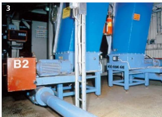
**1.** Дозирующая установка трех различных химических веществ для противопожарной защиты изделий из дерева.
